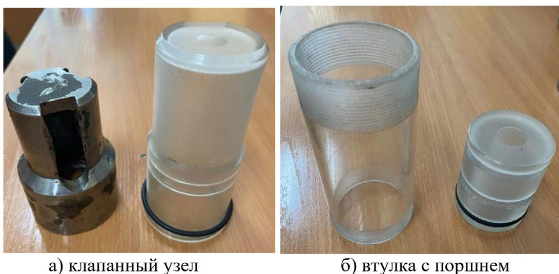
Рисунок 3.6 – Модели клапанного узла скважинного насоса НН2Б-57
