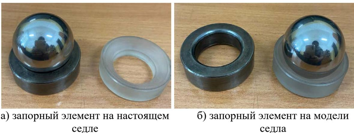
Рисунок 3.5 – Клапанный узел станда
